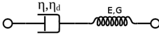
**Figura 1.12:** Modello di Maxwell: la componente viscosa è in serie con quella elastica, immagine modificata da [34].
